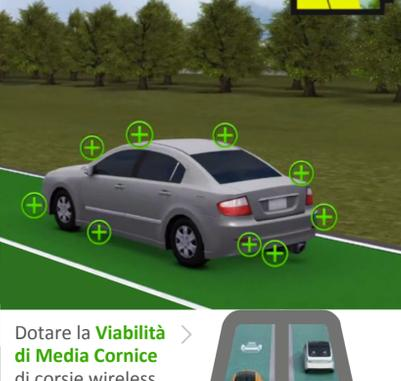
Dotare la **Viabilità di Media Cornice** per **ricaricare le auto elettriche in modo dinamico**, semplicemente passando sopra ad un dispositivo posizionato sotto il manto stradale.
